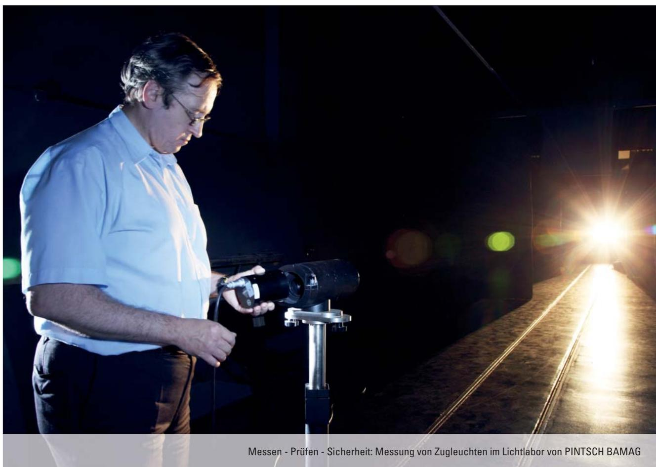
Messen - Prüfen - Sicherheit: Messung von Zugleuchten im Lichtlabor von PINTSCH BAMAG
