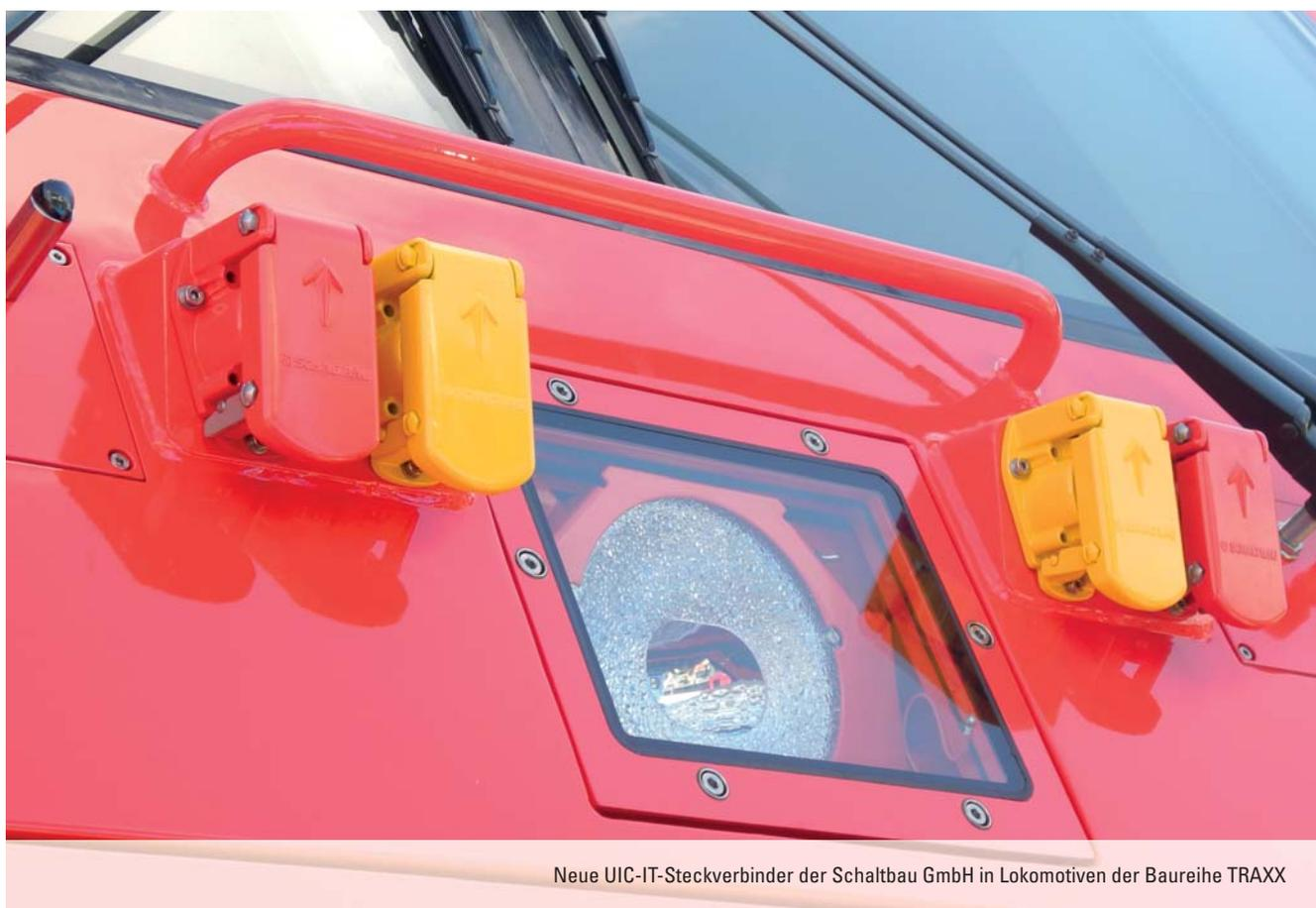
Neue UIC-IT-Steckverbinder der Schaltbau GmbH in Lokomotiven der Baureihe TRAXX
