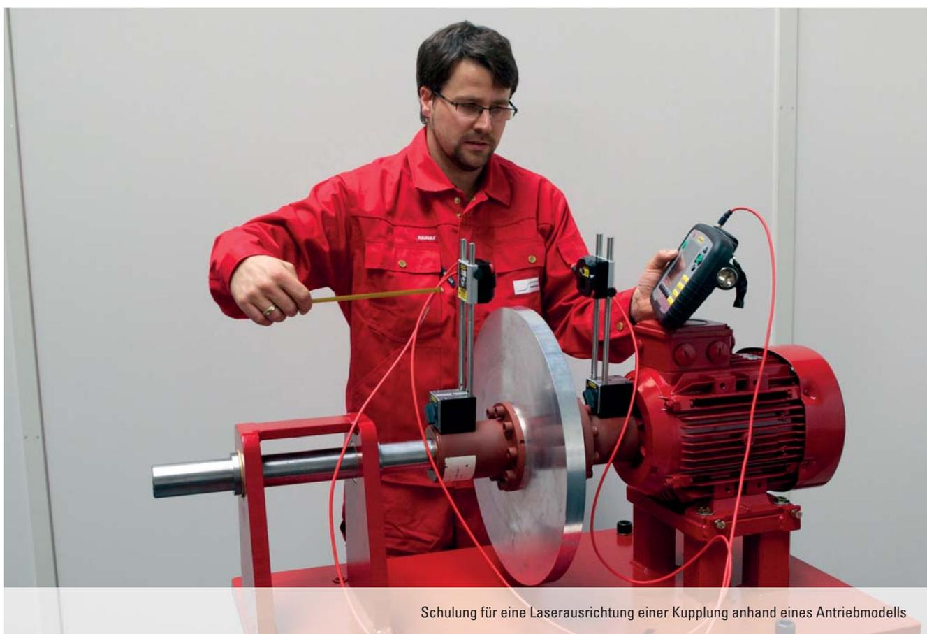
Schulung für eine Laserausrichtung einer Kupplung anhand eines Antriebmodells
